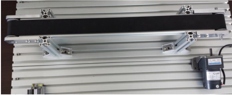
图 1 同步带物料输送机机械本体
