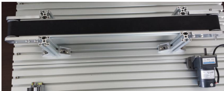
图 1 同步带物料输送机机械本体
