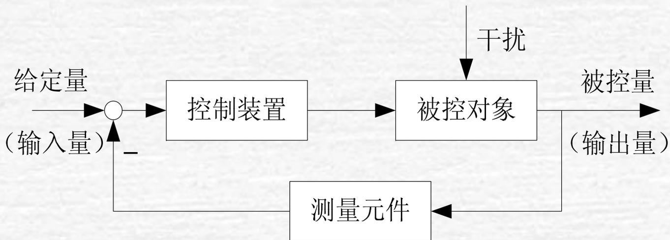
1、**信号线**：带有箭头的直线，箭头表示信号的流向，在直线旁标记信号的时间函数或象函数。
