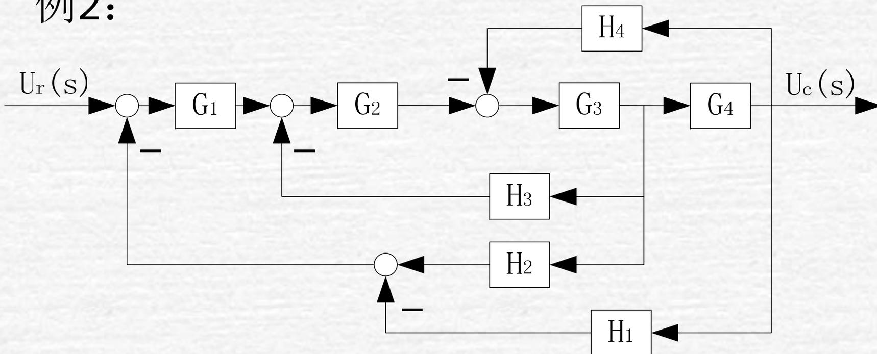
$$\frac{C(s)}{R(s)} = \frac{G_1 G_2 G_3 G_4}{1 + G_2 G_3 H_3 + G_3 G_4 H_4 + G_1 G_2 G_3 H_2 - G_1 G_2 G_3 G_4 H_1}$$
