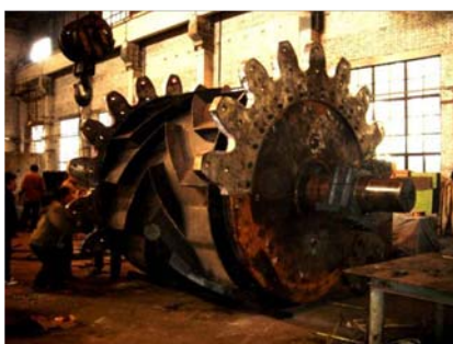
图3 偶数齿烧结机星轮制造现场
