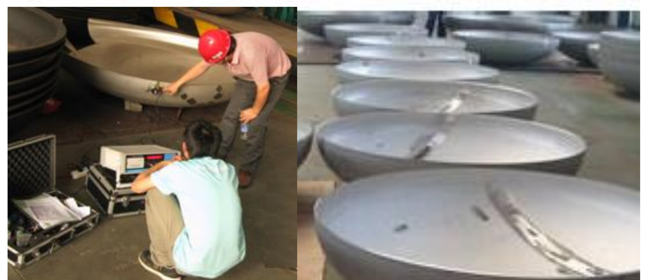
图5 成形的大型罐式集装箱封头
