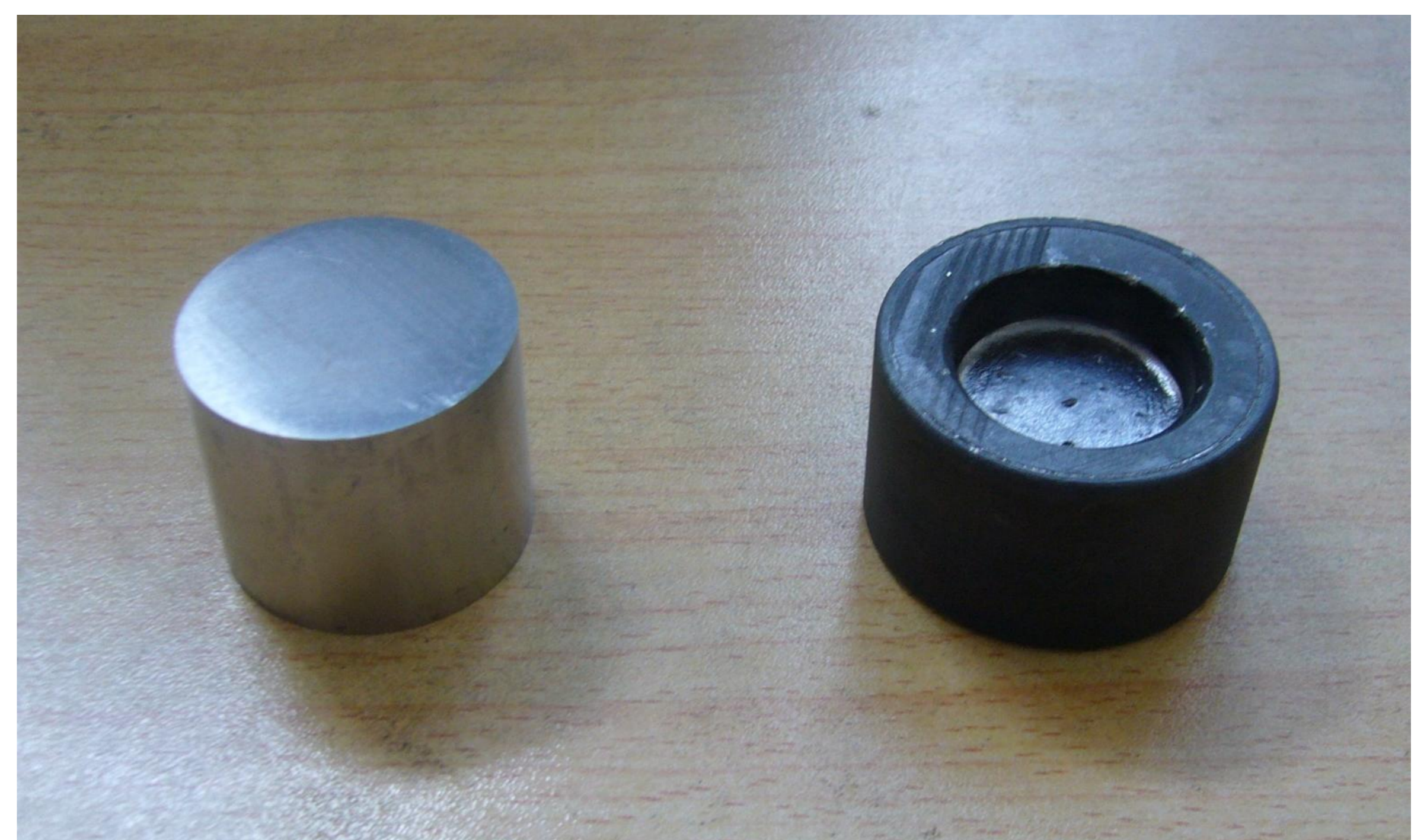
图2 电场辅助正反复合挤压锆合金轴承环
