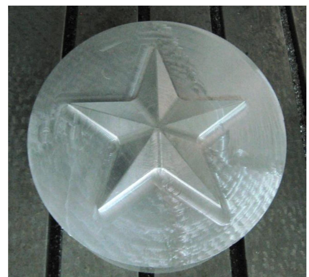
图4 并联机床在铝合金上雕刻的五角星
