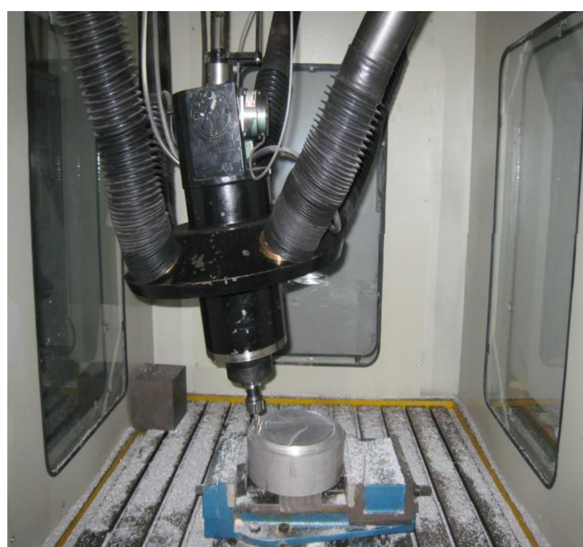
图3 并联机床在铝合金上铣削球冠
