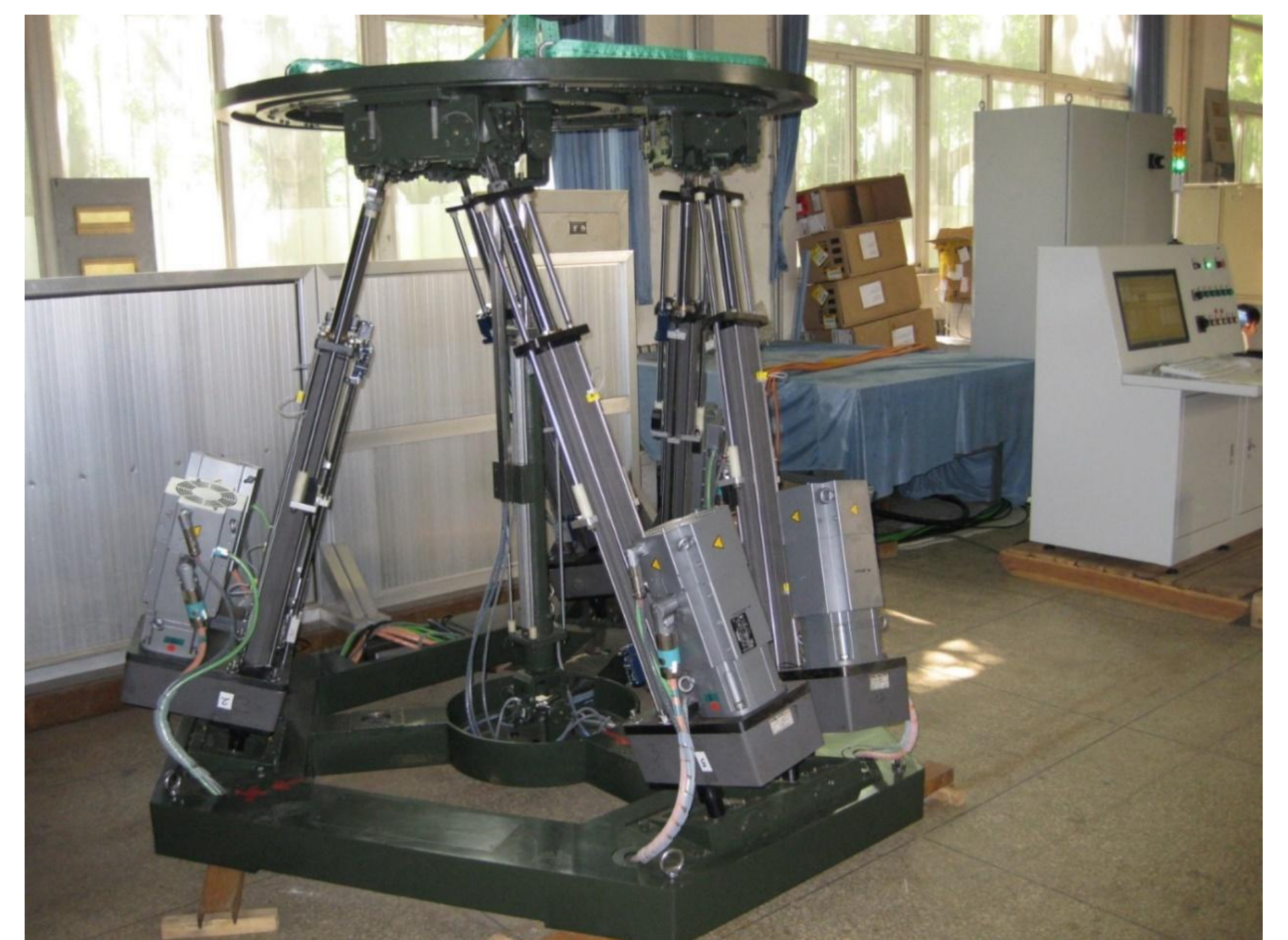
图1 高速、高精电驱六自由度并联运动模拟台系统
