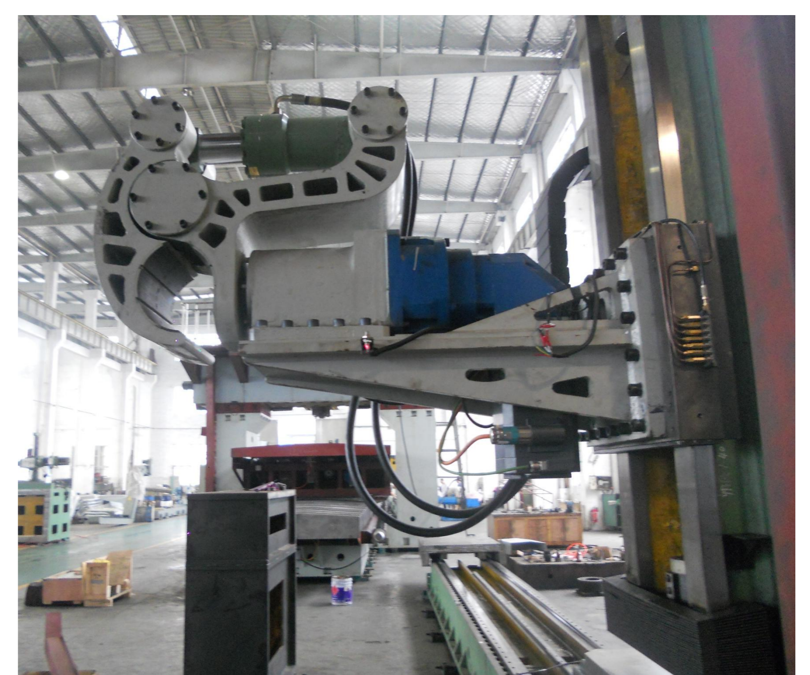
图4 安装于专机上的液压定向机械臂
