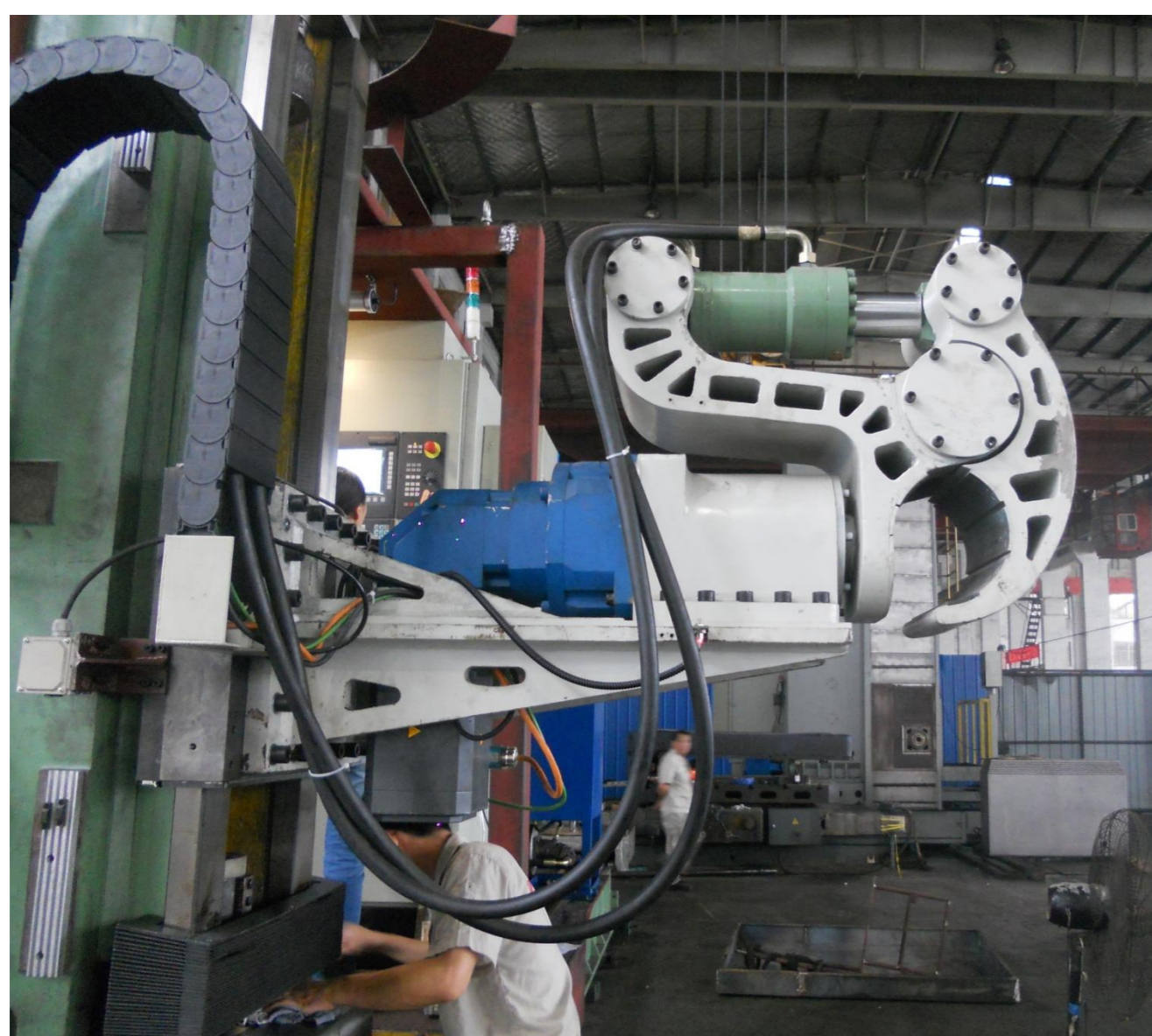
图1 安装在专机上的液压定向机械臂
