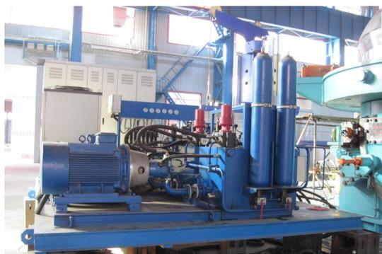
图1 变位器液压伺服与传动系统泵站
