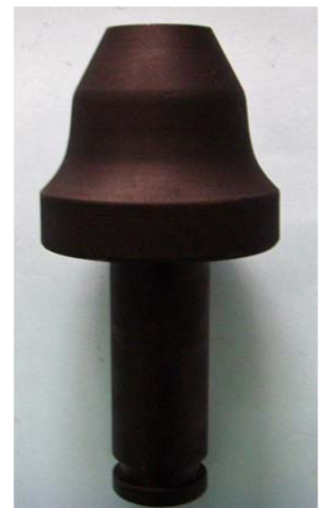
图5 浮动组合凹模技术成形大高径比制件
