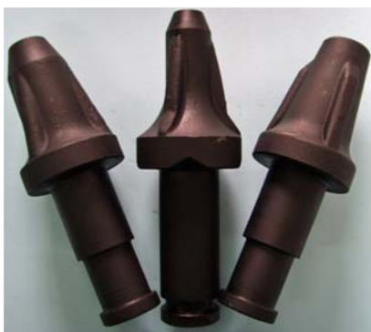
图3 复合挤压一次成形异型制件
