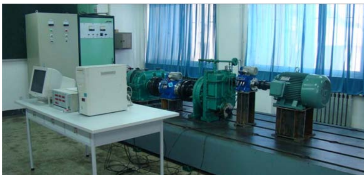
图2 30KW双馈/永磁同步风力发电试验平台
