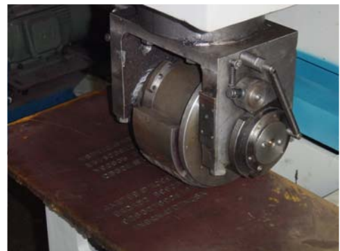
图2 板材压印机压印效果
