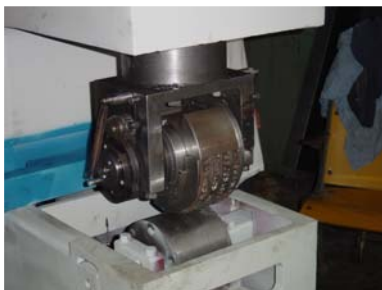
图1 板材压印机压印辊
