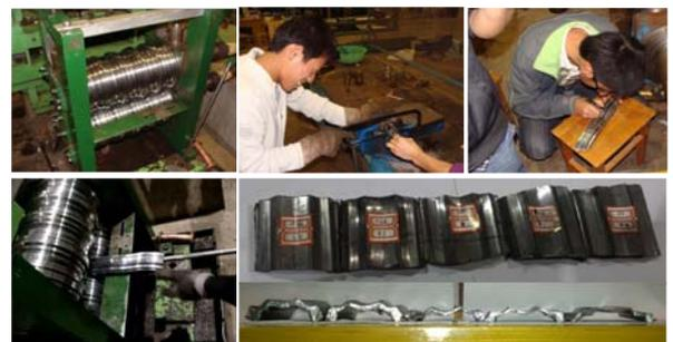
图2 Halfen预埋槽钢轧制试验
